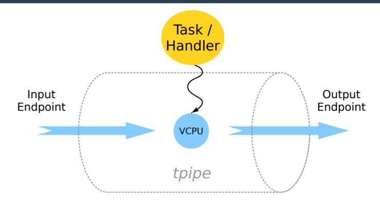
tpipe\_id\_t tpipe (ep\_t \*inp[], int n\_inp, ep\_t \*outp, qos\_t spec, tpipe\_task\_t func, void\* arg);
